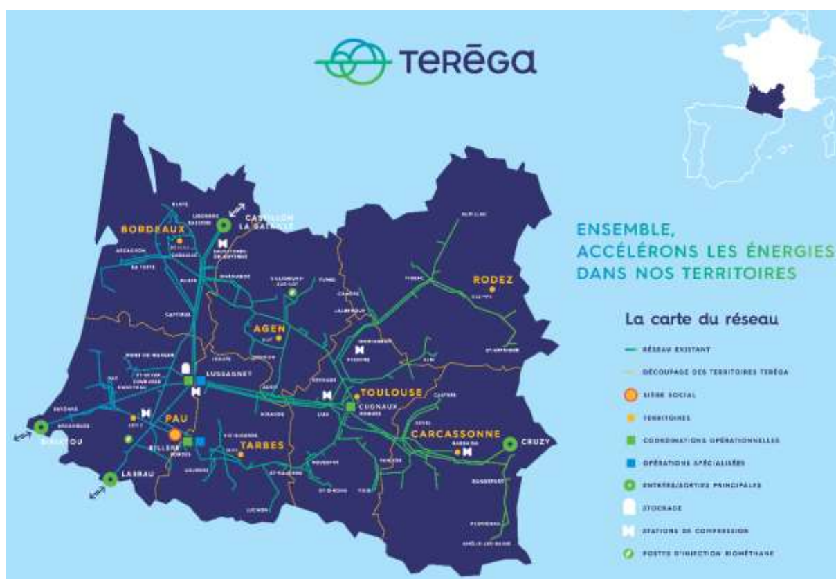
Figure 1 : Carte du réseau de Transport de Teréga
